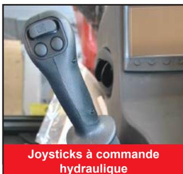
Joysticks à commande hydraulique
