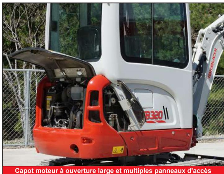
Capot moteur à ouverture large et multiples panneaux d'accès
