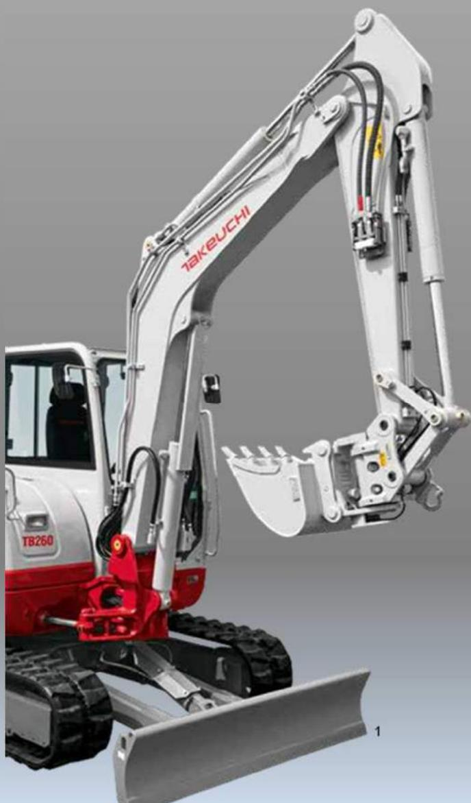
Vous pouvez régler le débit pour différents accessoires et les enregistrer avec un symbole correspondant. Une puissance par litre de 102,2 l/min est disponible sur le circuit auxiliaire primaire
