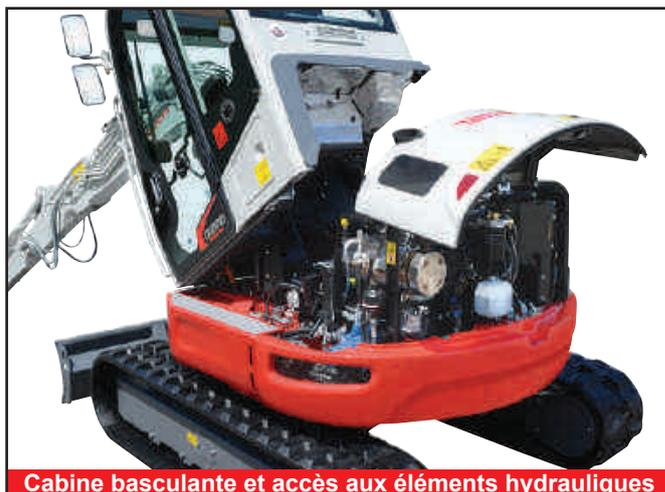
Cabine basculante et accès aux éléments hydrauliques
