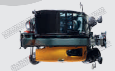
Marche en crabe Permet de se rapprocher facilement d'un mur.
