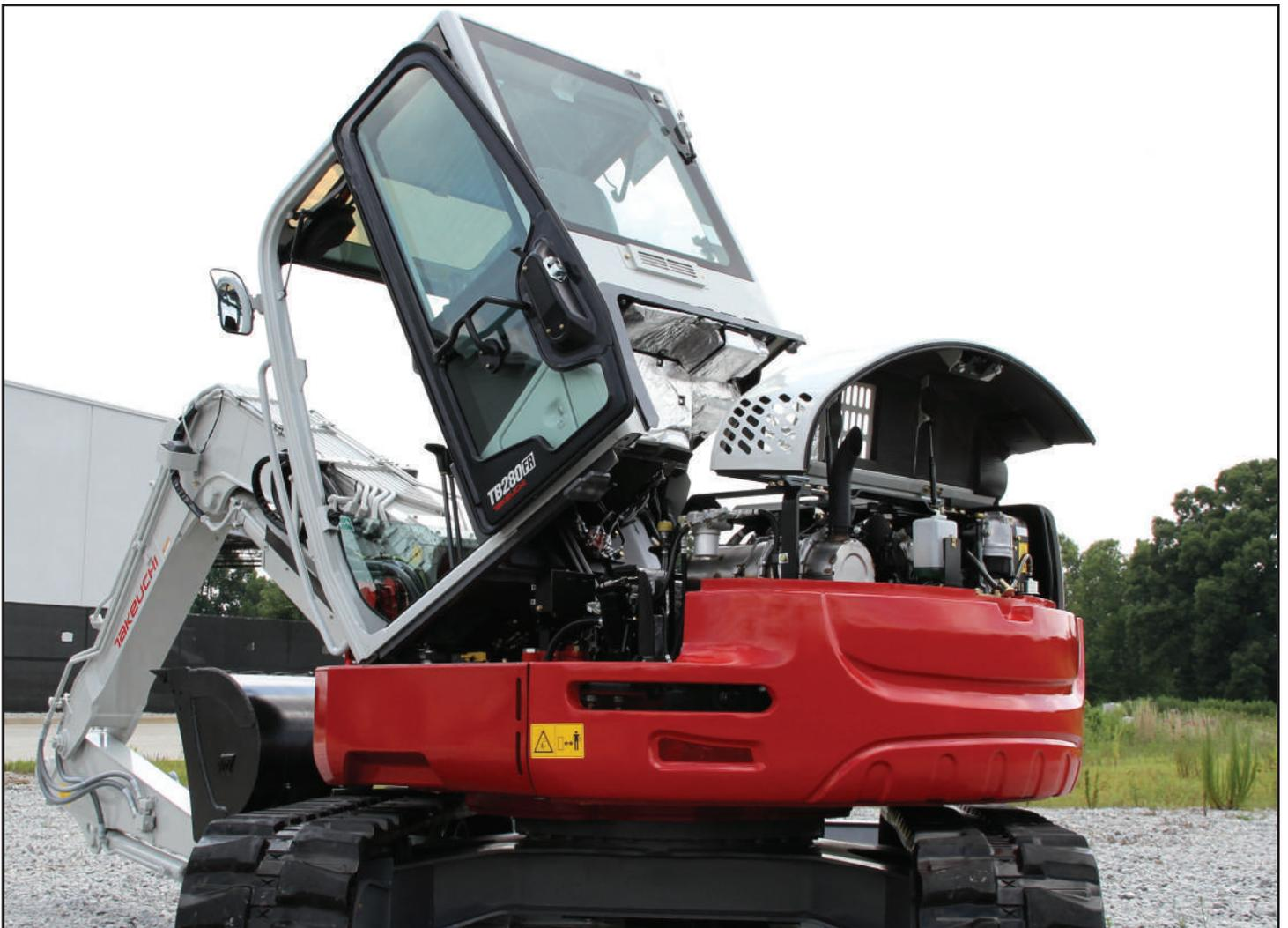
Cabine basculante pour un accès aisé aux différents composants hydrauliques
