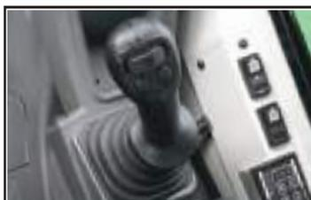
Joysticks à commande hydraulique
