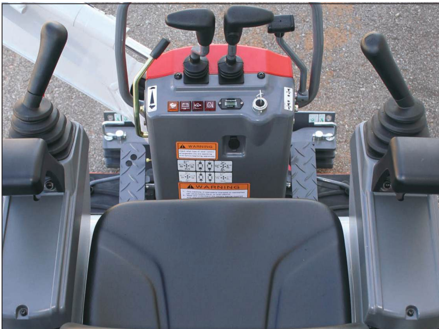
Poste de conduite spacieux et joysticks à commande hydraulique
